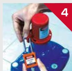
Cubra la base del dispositivo de bloqueo con su tapa y alinee los orificios laterales de base y tapa para bloquear el dispositivo con un candado.
