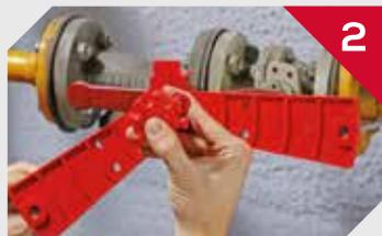
Sitúe el brazo del bloqueo donde quiera fijarlo. Si su bloqueo es de brazo doble, presione sobre el eje para girar el segundo brazo y ponerlo donde lo quiera fijar.
