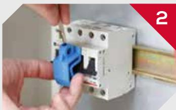
Apriete el tornillo interior para fijar el bloqueo al interruptor.
