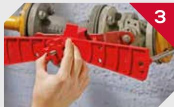
Gire el eje rotatorio hasta conseguir la máxima sujeción. Después, introduzca uno o dos candados para dejar el dispositivo correctamente fijado.
