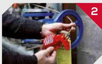
Introduzca el cable por el orificio en el lateral del portacandados y ténselo. (Se recomienda señalizar la zona con una etiqueta. Pásela por el cable antes de introducir éste en el portacandados).
