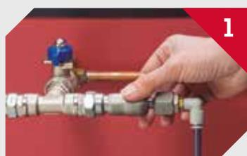
Separe la boquilla del elemento neumático.
