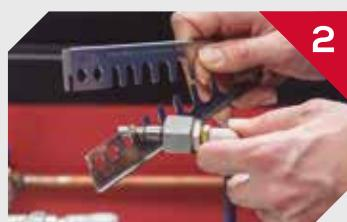
Introduzca la boquilla en la toma del dispositivo de bloqueo que mejor se adapte a su diámetro.
