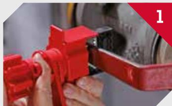
Presione el eje para abrir la mordaza del bloqueo y así poder introducirla en la llave de paso de la válvula.
